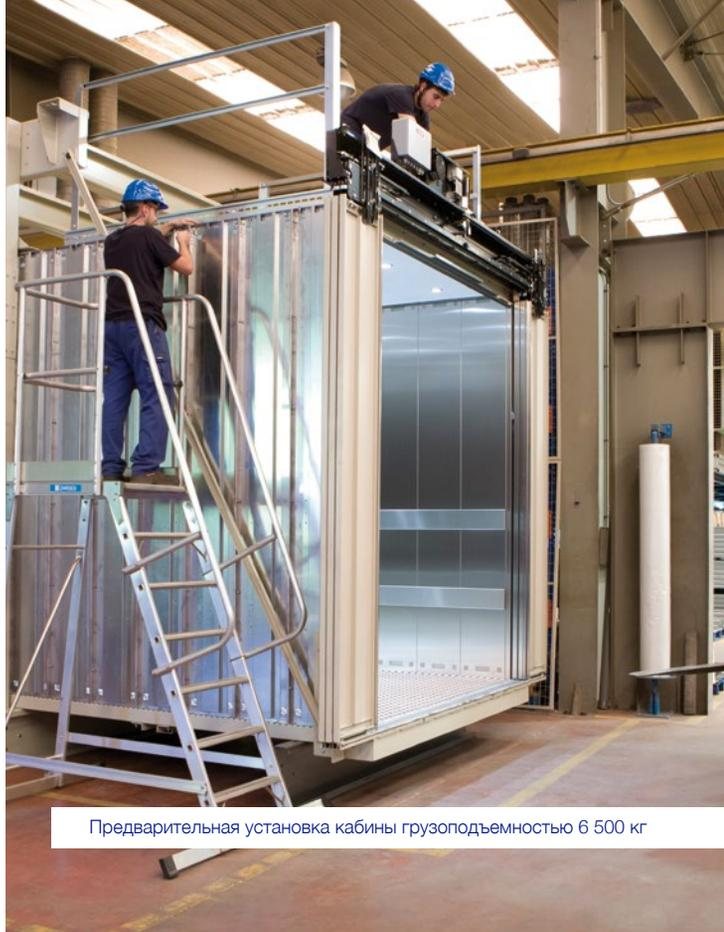
Предварительная установка кабины грузоподъемностью 6 500 кг
