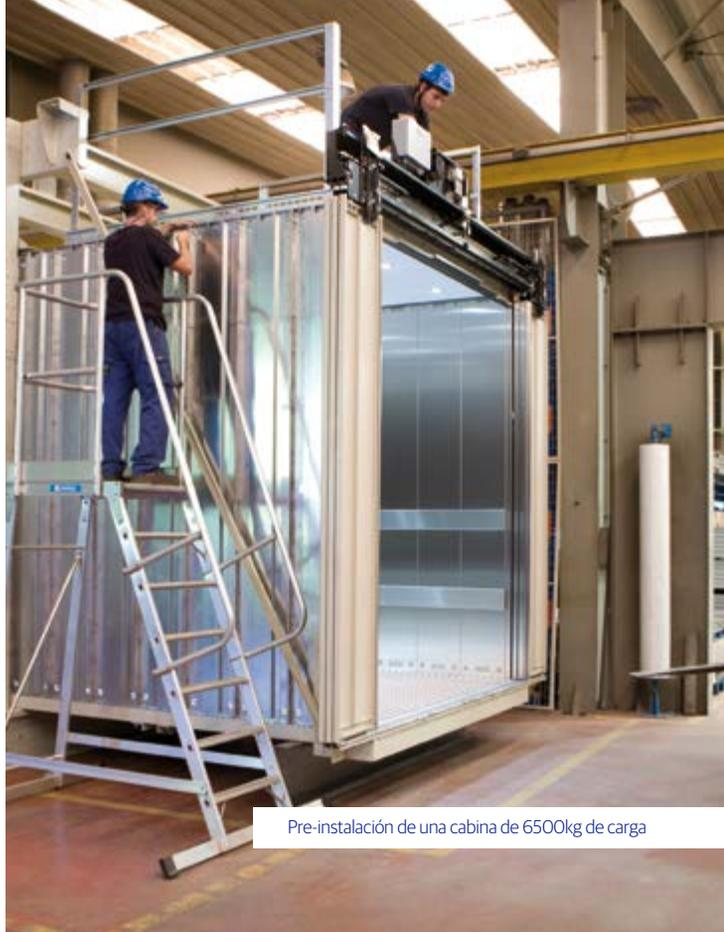
Pre-instalación de una cabina de 6500kg de carga
